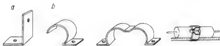
Rys. 2. Pomocnicze detale montażowe a — kątownik, b — obejma
